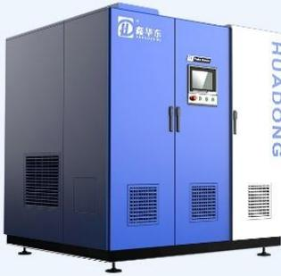
磁悬浮高速离心鼓风机，是一款百分百无接触无摩擦实现智能控制的高效节能环保产品，由磁悬浮轴承，高效永磁同步电机，高效离心叶轮等核心部件组成，有效节电30%以上，噪音低于85分贝，后期基本免维护。
